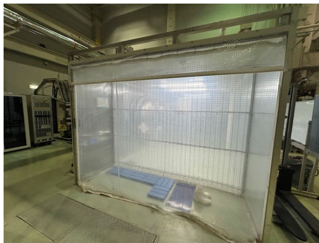
図2-9 クリーンブースの外観
