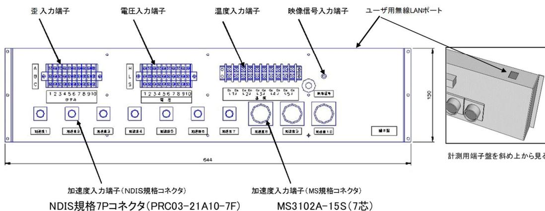
図4-3 計測用端子盤
