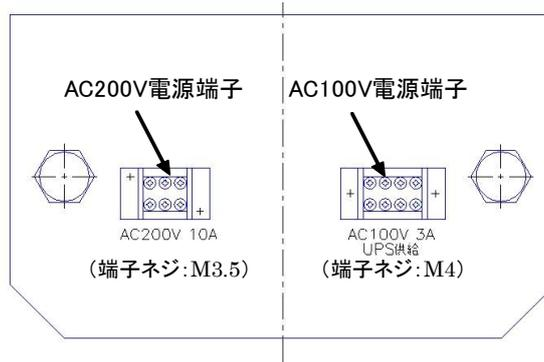
図4-5 供試体用電源端子
