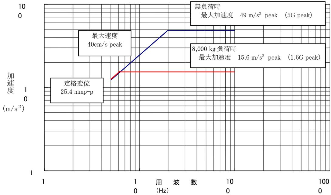
図2-4 最大加振加速度（垂直振動台）
