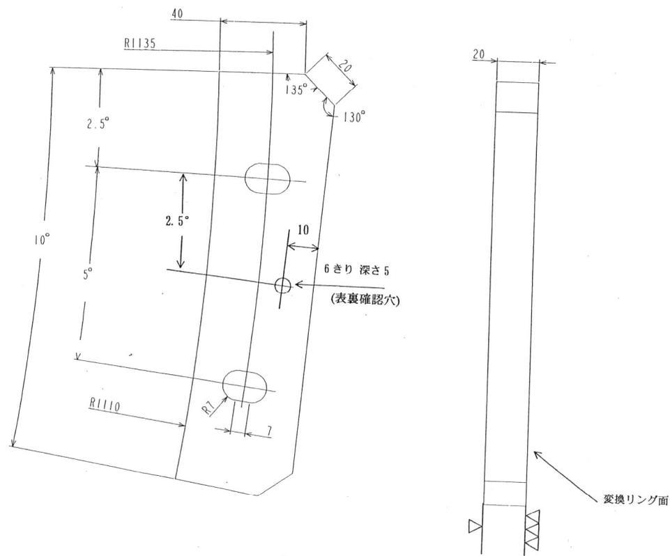
注) 本ストップ・ブロックは、水平加振時において PAF の滑り止めとして、PAF1666MA または同等サイズの PAF に使用する事が出来ます。水平振動台用ネジ穴変換リングへのストップ・ブロックの取付手順は、4.4 項を参照して下さい。
