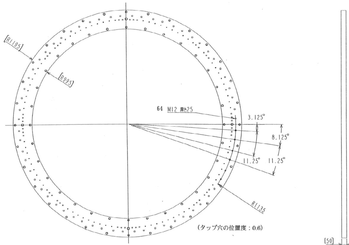
図3-7 振動台ネジ穴パターン図 (水平振動台用ネジ穴変換リング)
