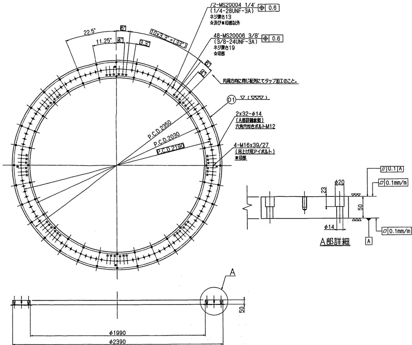
図3-5 振動台ネジ穴パターン図 (垂直振動台用ネジ穴変換リング)
