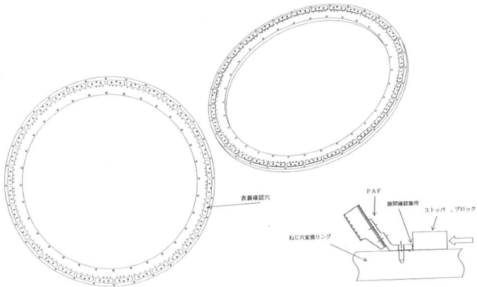
図3-9 水平振動台用ネジ穴交換リング ストップ・ブロック取付図
