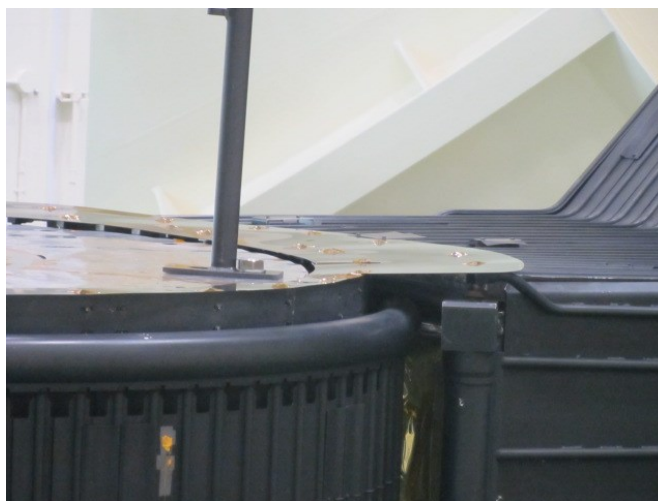
図3-26 テストフィクスチャスピントーブルとシュラウドカバーの位置関係
